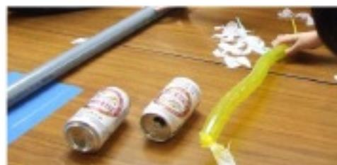
アルミの空き缶は静電気を帯びたバルーンには反発して遠ざかります！
